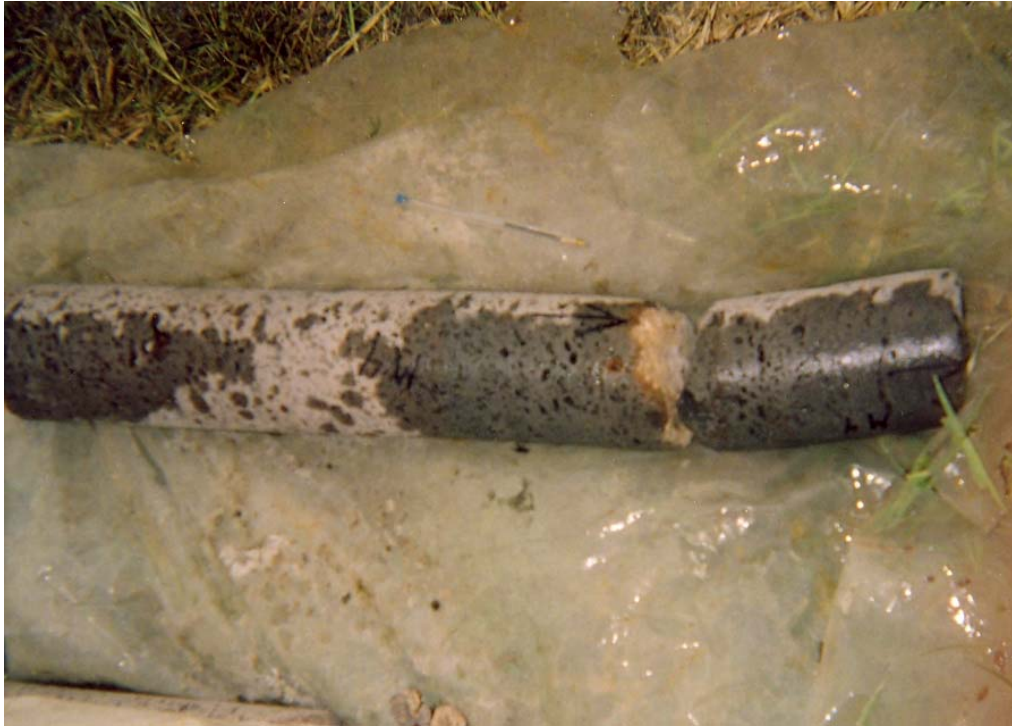
Fotografía 21. Muestra de roca basáltica vesicular, recuperada con el barril NQ.
