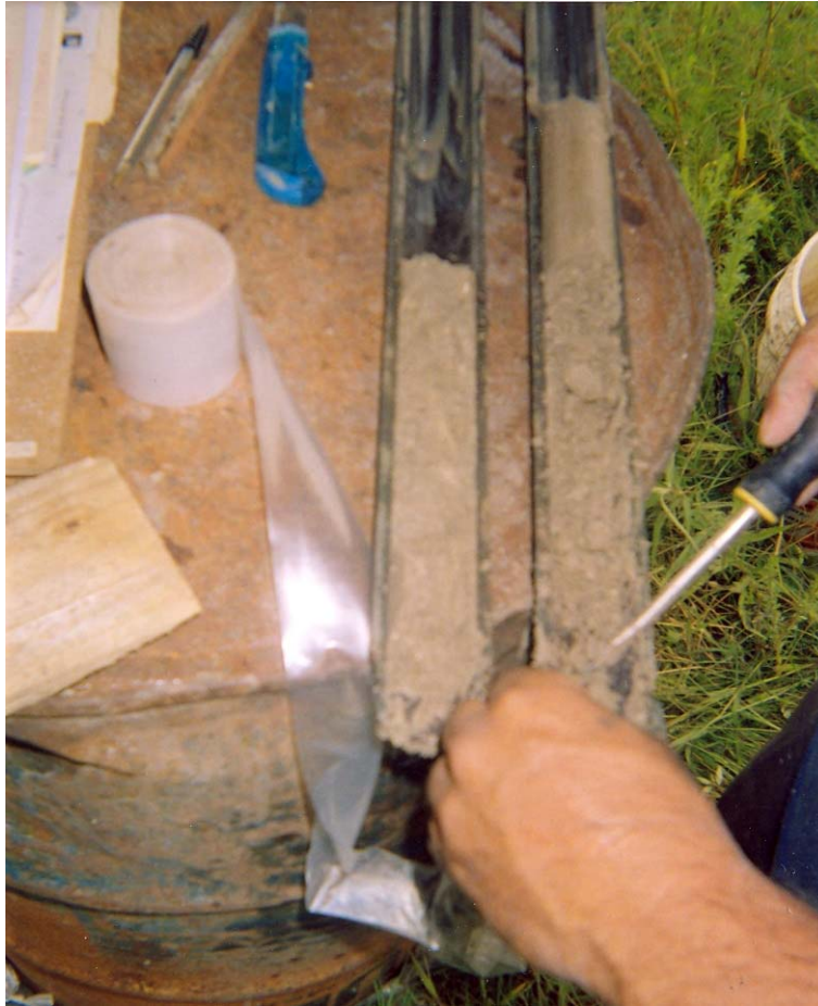
Fotografía 15. Extracción de muestras alteradas obtenidas con la herramienta de penetración estándar.
