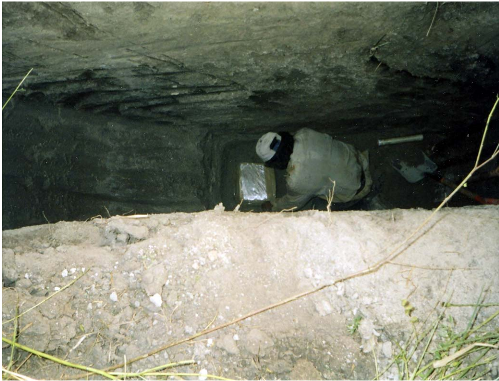
Fotografía 30. Protección de la muestra cúbica dentro del PCA-1.
