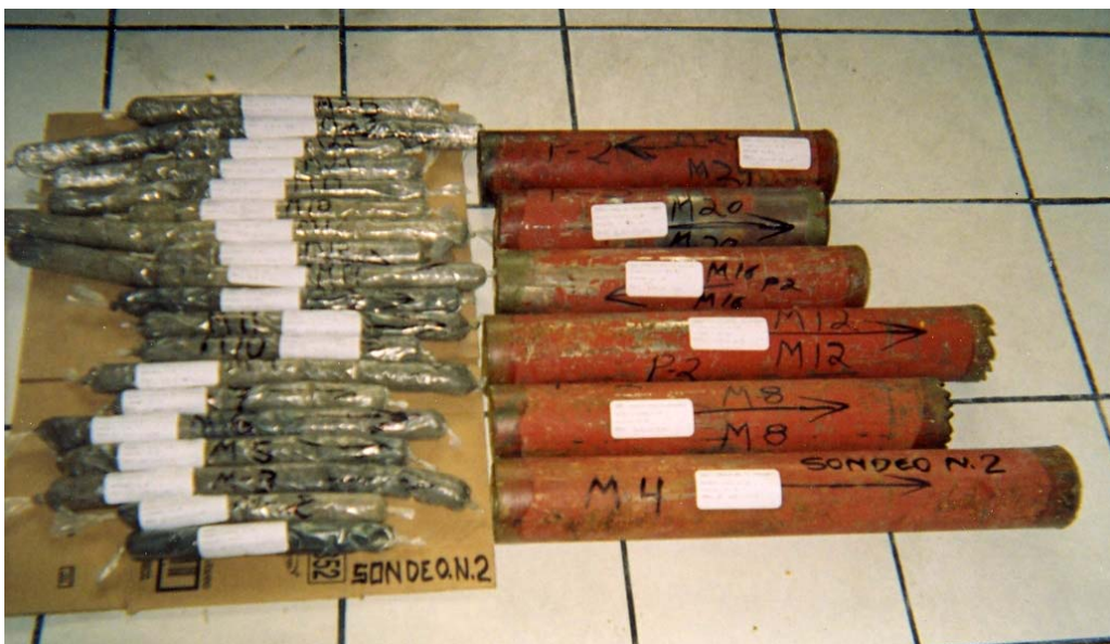
Fotografía 16. Aspecto de las muestras de suelo alteradas con herramienta de penetración estándar (izq.) e inalteradas con tubo shelby (der.) del sondeo mixto dos.
