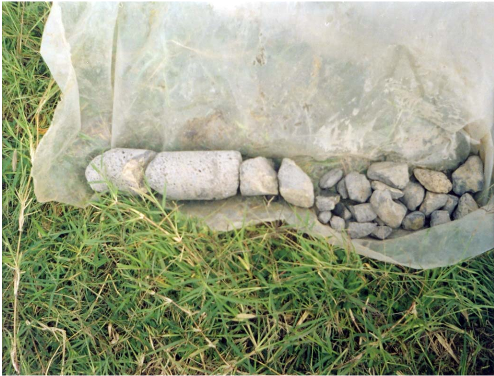
Fotografía 19. Gravas y roca volcánica vesicular, recuperadas con el barril NQ.
