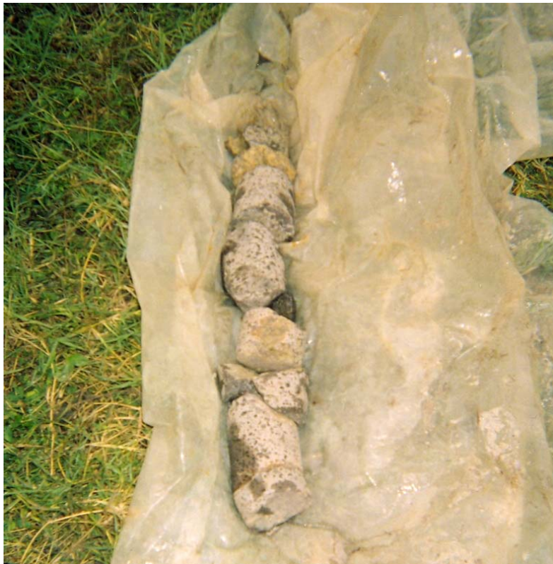
Fotografía 20. Otro aspecto del basalto vesicular recuperado con el barril NQ.
